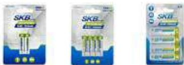
Accumulatore al NiMh progettato per tutte le applicazioni dove è necessario avere un funzionamento garantito da un'ampia affidabilità. Accetta la carica standard (1/10 della capacità in 16 ore) oppure carica rapida (C) con una temperatura di 25°C. Garantisce 1000 cicli di carica/scarica. Conforme a tutte le normative internazionali.
