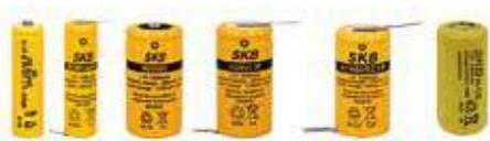
Accumulatore al NiCd progettato per tutte le applicazioni dove è necessario avere un funzionamento garantito da un'ampia affidabilità. Accetta la carica standard (1/10 della capacità in 16 ore) oppure carica rapida (C) con una temperatura di 25°C. Garantisce 1000 cicli di carica scarica. Conforme a tutte le normative internazionali.
