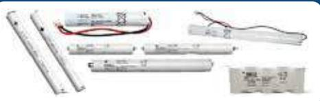
Batteria al NiCd progettata per l'utilizzo in lampade di emergenza a parete dove è necessario avere un funzionamento garantito ad alta temperatura (55°C). Accetta la carica standard (1/10 della capacità in 16 ore) oppure la carica permanente (1/20) ad una temperatura di 55°C. Conforme a tutte le normative internazionali Europa(IEC61951) e USA (UL924)
