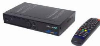
Predisposto per la ricezione streaming in protocollo IPTV. Display frontale a 4 digit. In DVB-S/S2 compatibile con impianto a singolo LNB, Multifeed (commutazione DiSEqC 1.0 e 1.1) e con sistemi motorizzati DiSEqC 1.2. Porta LAN RJ45 per accesso alla rete Internet con App precaricate.
