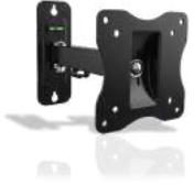
Per TV da 10" a 23" con peso massimo di 15Kg e attacco VESA 75x75 e 100x100. Grazie al braccio e i 2 snodi è possibile spostarlo dal muro per una facile pulizia, fino ad un massimo di 250mm. Quando completamente chiuso, la distanza dal muro è di soli 65mm. Inoltre, è possibile inclinare la televisione per una massimo di 15° e ruotarla di 90°. La livella inclusa nella staffa, facilita l'installazione al muro.
