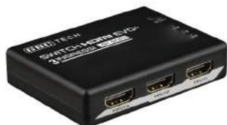
3 ingressi selezionabili da pulsante fisico o tramite telecomando IR incluso. Supporta le risoluzioni video Full HD 1080p e UHD 4Kx2K@60Hz. Consente l'utilizzo del Deep color 12bit per canale (36bit in totale) e della funzione CEC. I formati audio supportati sono audio Digitale, DTS-HD/Dolby trueHD, non compresso come LPCM e audio 7.1 surround. Ampiezza di banda 6Gbps @600MHz per canale (18Gbps in totale). HDCP 2.2 supportato.
