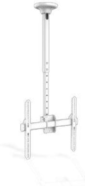
Per TV da 32" a 55" con peso massimo di 50Kg e attacco VESA massimo di 400x400. Grazie al braccio telescopico la distanza dal soffitto può essere da 560mm a 910mm. Inoltre, è possibile inclinare la televisione per una massimo di 25° e ruotarla di 90°.
