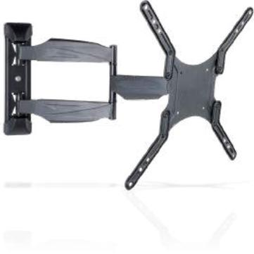
Per TV da 26" a 42" con peso massimo di 30Kg e attacco VESA massimo di 400x400. Grazie ai 2 bracci e ai 3 snodi è possibile spostarlo dal muro per una facile pulizia, fino ad un massimo di 531mm, è inoltre possibile ruotare la TV a 90°. Quando completamente chiuso, la distanza dal muro è di soli 46mm. Inoltre, è possibile inclinare la televisione per una massimo di 12° e ruotarlo di 90°.
