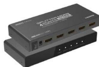
4 uscite con risoluzione video massima UHD TV 4Kx2K a 3840x2160 @60Hz. Supporta Deep Color a 36bit, HDCP 2.2 e HDR. Funzione downscaling per compatibilità con display o video proiettori di destinazione con diverse risoluzioni. I formati audio supportati sono DTS-HD/Dolby-trueHD e LPCM non compresso. Ampiezza di banda totale 18Gbps.
