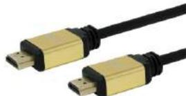
Cavi HDMI HEAC High Speed con Ethernet con canale ARC High End, per TV UHD 4K, Decoder SAT e DVB-T2, game console e lettori Blu-ray; supportano 4Kx2K 60fps, con banda passante di 10,2 o 18Gbps; con funzione ECCM per evitare interferenze audio. Conduttore in rame. Connettori in alluminio con finitura Gold assemblati.
