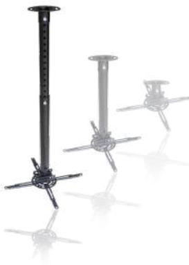
Per tutti i proiettori con peso massimo di 21Kg. Grazie al braccio telescopico la distanza dal soffitto può essere da 120mm a 822mm. Inoltre, è possibile inclinare il proiettore un massimo di 10° e ruotarlo di 360°.
