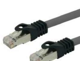
Cavo di rete Ethernet con connettori RJ45, schermati S/FTP (Screened Foiled Twisted Pair), certificati in Cat. 7 (ISO/IEC 11801 Class F). Conduttore in rame. Doppia schermatura, alluminio-mylar su ogni singola coppia e calza in alluminio-magnesio. Con la diffusione delle nuove connessioni internet e intranet ultra veloci, la Cat. 7 sfrutta al massimo le potenzialità delle reti a 10/100/1000Mbps (la velocità di trasmissione raggiunge i 10Gbps, garantiti fino a 100m).
