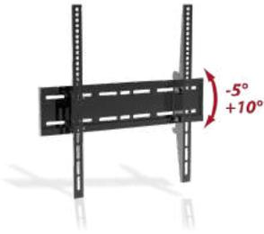
Per TV da 23" a 55" con peso massimo di 40Kg e attacco VESA massimo di 400x400. La distanza dal muro è di soli 45mm. Inoltre, è possibile inclinare la televisione per una massimo di 10°. La livella inclusa nella staffa, facilita l'installazione al muro. Mentre la vite di sicurezza, blocca il televisore al supporto e ne impedisce la rimozione.
