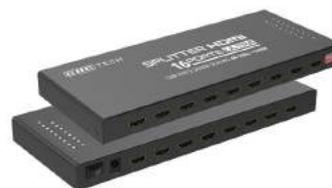
16 uscite con risoluzione video massima UHD TV 4Kx2K a 3840x2160 @60Hz. Supporta Deep Color a 36bit, HDCP 2.2 e HDR. Funzione downscaling per compatibilità con display o video proiettori di destinazione con diverse risoluzioni. I formati audio supportati sono DTS-HD/Dolby-trueHD e LPCM non compresso. Ampiezza di banda totale 18Gbps.
