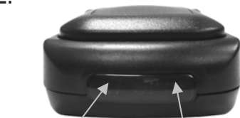
Tx: LED IR Rx: IR Sensor Anzeige ON/OFF
